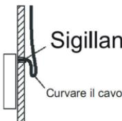
In fase di installazione, lasciare una lunghezza del cavo di collegamento sufficiente per consentire una più semplice rimozione della Smart port durante la manutenzione.
