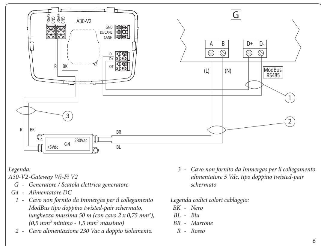
N.B.: in alternativa ai morsetti "A" e "B" l'alimentatore (G4) può essere collegato direttamente alla rete elettrica 230 Vac / 50 Hz
