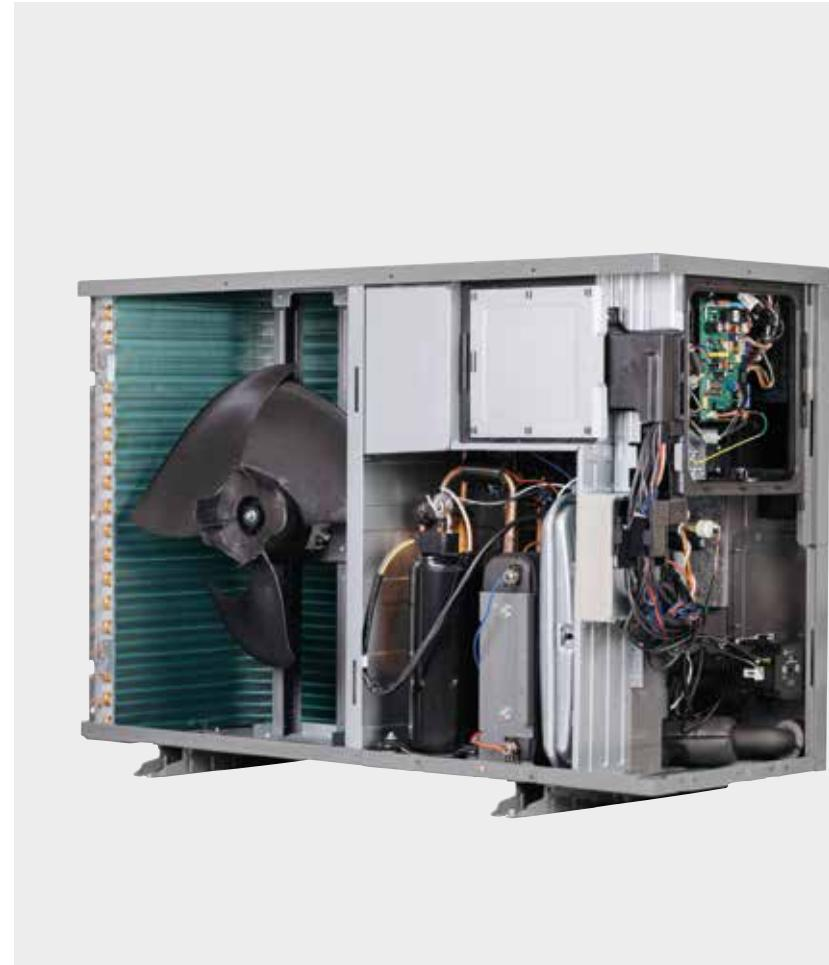
**Circuito frigorifero dotato di compressore inverter** (Rotary per versioni 5-8 e Scroll per versioni 12-16), valvola di espansione elettronica bi-flusso, valvola d'inversione a 4 vie, pressostati di alta e bassa pressione
