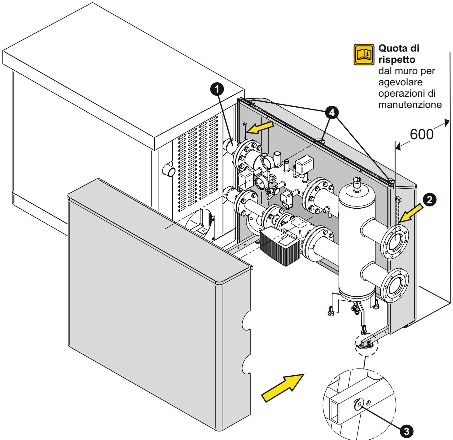
Agganciare la copertura posteriore mediante le fascette indicate, all'adattatore 1 e al separatore 2.
